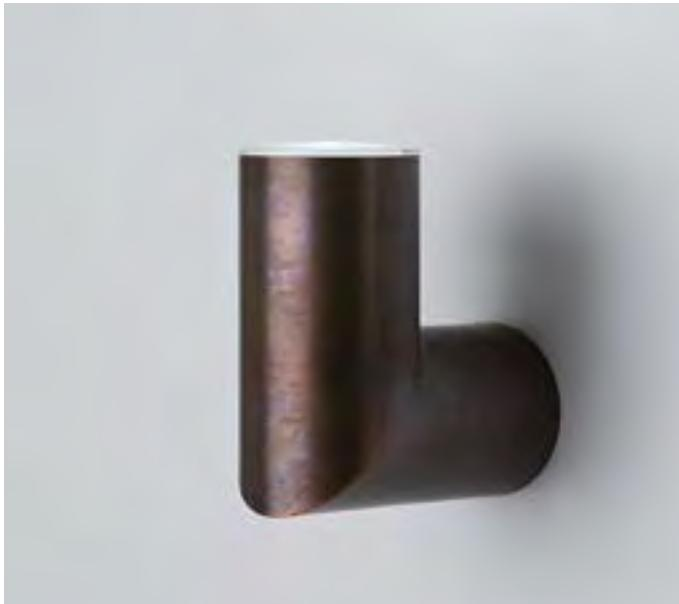
Applique LED a mono-emissione per interni ed esterni. Corpo dissipante interno in alluminio anodizzato nero e corpo esterno in ottone naturale tornito. Ottica ad emissione spot 20°, 30° o 50° in policarbonato. Schermo superiore tornito in PMMA trasparente. Alimentazione on/off integrata
