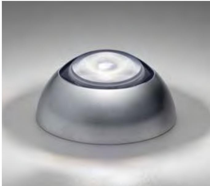
Incasso LED per esterno ad emissione spot. Corpo interno dissipante in alluminio anodizzato, lente in PMMA trasparente vibrolucidato e flangia in Acciaio Inox Aisi 316L o bronzo naturale.
