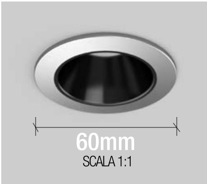
Incasso LED per interni ed esterni. Corpo dissipante realizzato in alluminio tornito anodizzato nero. Flangia superiore in Alluminio tornito con finitura verniciata o trattamento galvanico. Schermo superiore tornito in PMMA trasparente con guarnizioni OR per garantire la tenuta stagna del prodotto.
