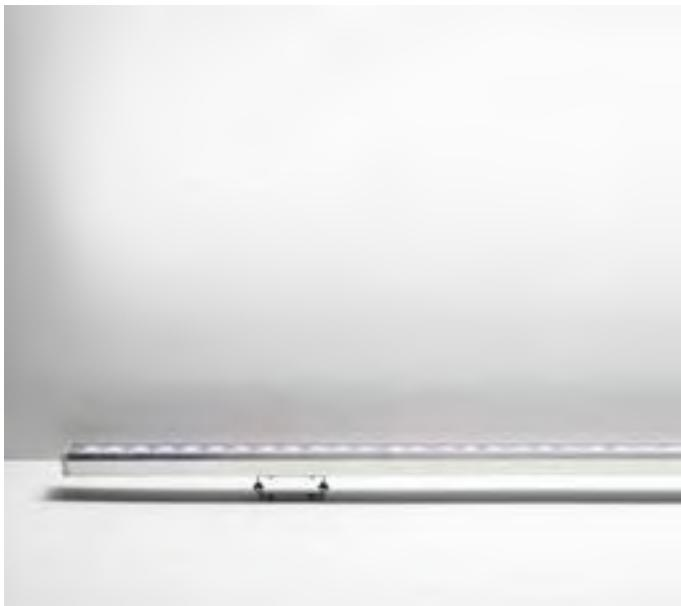
Profilo LED lineare per esterni. Ideale per l'illuminazione architettonica di edifici e facciate. Profilo dissipante trafilato in alluminio, con lavorazione CNC, schermo in vetro extrachiaro serigrafato e staffe in Acciaio Inox AISI316L. Ottica ad emissione spot o ellittica in PMMA trasparente.
