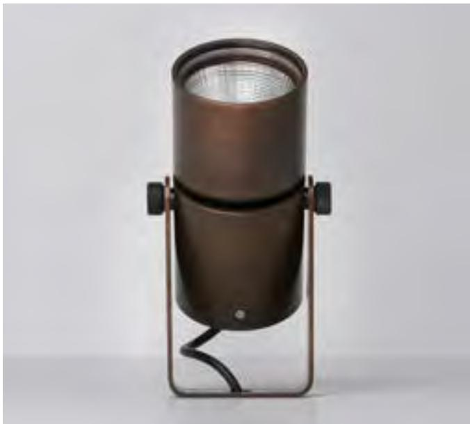
Proiettore LED per interni ed esterni . Ideale per l'illuminazione d'accento o di medie/grandi alberature . Corpo realizzato da tornitura di alluminio con trattamento superficiale di verniciatura o rame naturale. Ottica ad emissione spot 20°, 30°, 50° o 75° e schermo in PMMA trasparente. Alimentazione on/off integrata.
