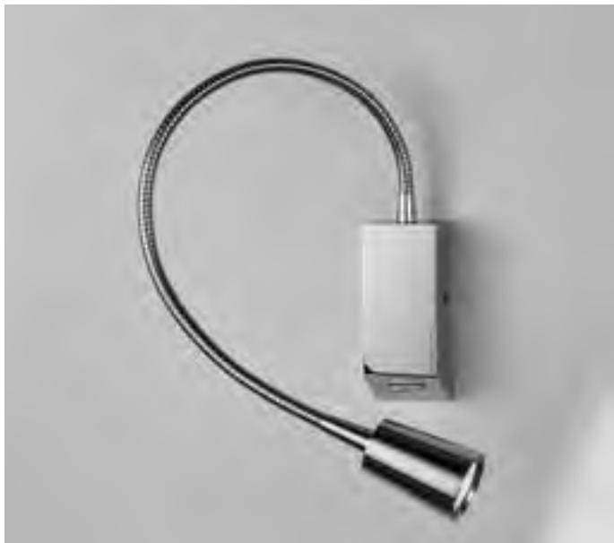
Applique LED per interni con braccio flessibile ed interruttore. Ideale per testa letto e luce da lettura. Testa lampada in alluminio tornito, braccio flessibile in ottone e scatola di alimentazione/fissaggio in pressofusione di zama. Trattamento superficiale di galvanica Cromo Lucido o Opaco. Ottica spot 30° in PMMA trasparente.
