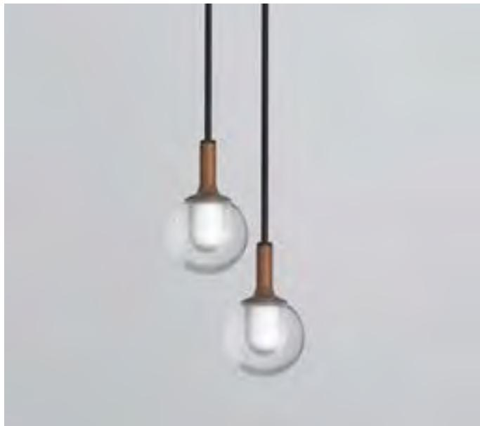
Sospensione LED con ottica ad emissione diffusa 360°. Ideale per l'illuminazione d'ambiente. Corpo dissipante realizzato in alluminio tornito con ossidazione anodica nera. Ottica ad emissione radiale 360° realizzato da monoblocco di PMMA trasparente tornito. Asta in ottone tornito verniciato. Alimentazione on/off integrata.
