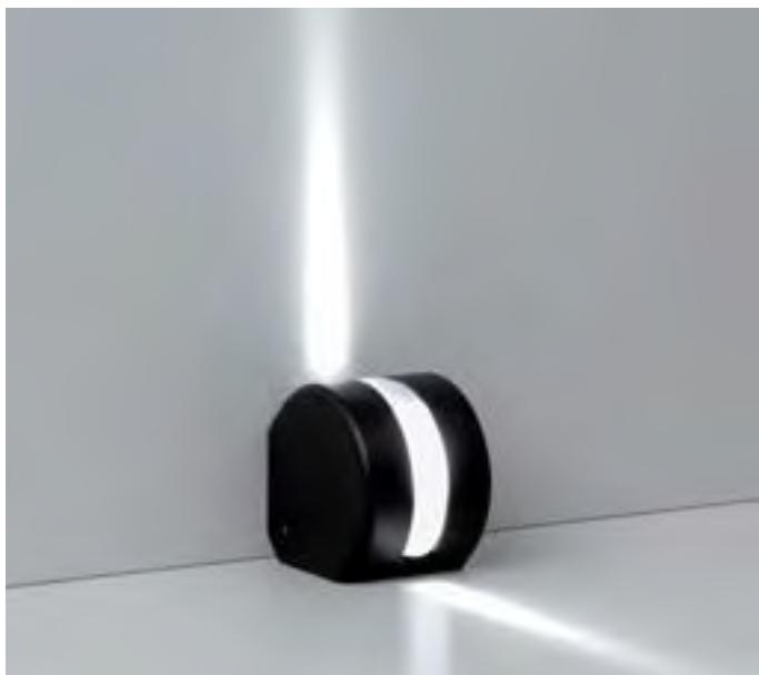
Plafone LED da esterno ed interno per l'illuminazione architettonuale di edifici e strutture con ottica asimmetrica. Corpo lampada in alluminio ricavato da macchina CNC e lente tornita da monoblocco di PMMA trasparente 8°x90°. Finitura superficiale di micro pallinatura e anodizzazione o verniciatura RAL. Sorgente LED multi-chip con resinatura incapsulante trasparente.
