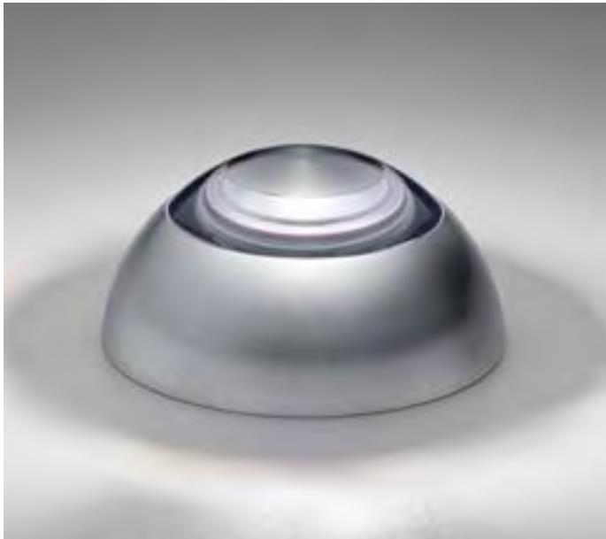
Segnapasso LED da incasso da esterno ad emissione radiale. Corpo in alluminio anodizzato, lente in PMMA trasparente vibrolucidato, ghiera e schermo torniti in Acciaio Inox Aisi 316L o bronzo naturale. Ottica ad emissione radiale 360°, monodirezionale 180°, 90° o bidirezionale 90/90°.
