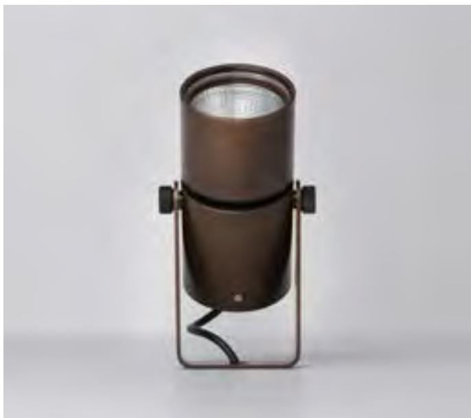
Proiettore LED per interni ed esterni . Ideale per l'illuminazione d'accento o di piccole o medie alberature . Corpo realizzato da tornitura di alluminio con trattamento superficiale di verniciatura o rame naturale. Ottica ad emissione spot 20°, 30° o 50° e schermo in PMMA trasparente. Disponibile con Scatola di alimentazione integrata 220/240Vac.
