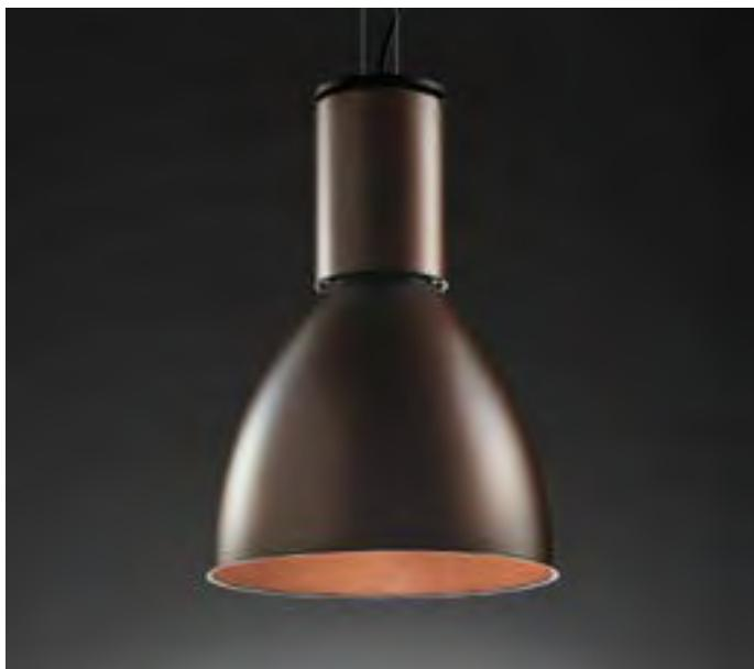
Sospensione LED con ottica ad emissione diffusa 60° o 120°. Ideale per l'illuminazione d'ambiente , uffici e centri tavolo. Corpo lampada in alluminio tornito e campana in alluminio tornito da lastra, microsatinatura superficiale ed anodizzazione o verniciatura. Ottica interna in policarbonato e possibilità di integrare lo schermo antiglare in PMMA micro-prismato trasparente (UGR<19).
