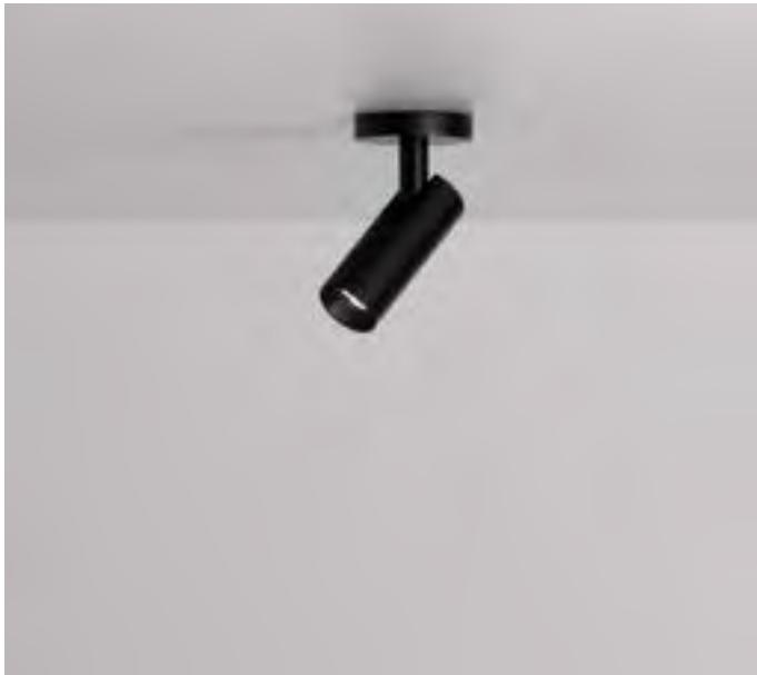
Proiettore LED orientabile da interno con base low-profile e molla per fissaggio su pannello o cartongesso. Ideale per l'illuminazione d'accento. Corpo lampada realizzati in alluminio tornito con verniciatura a polvere epossidica. Snodo in ottone tornito e base in ferro verniciato. Disponibili varie ottiche in PMMA trasparente. Anello frontale antiglare in alluminio anodizzato nero.
