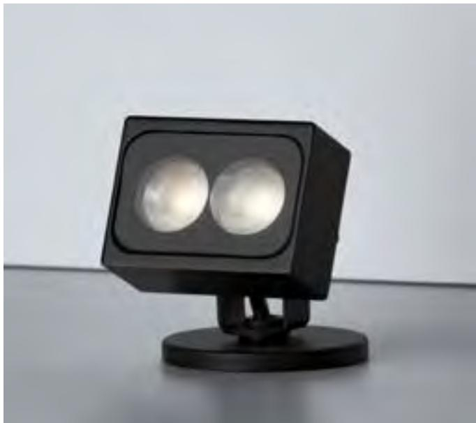
Proiettore LED direzionale per esterni con fissaggio a picchetto. Ideale per l'illuminazione d'accento. Corpo in alluminio Anodizzato nero pressofuso. Staffa di orientamento e fissaggio in Acciaio Inox Aisi 316. Doppia ottica in PMMA trasparente.
