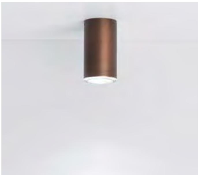
Plafone LED per interni ed esterni. Corpo dissipante interno in alluminio anodizzato nero e corpo esterno in ottone naturale tornito. Ottica ad emissione spot 12° o 30° in PMMA trasparente.
