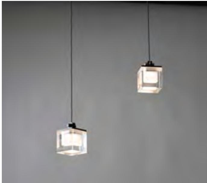
Sospensione LED per interni. Ideale per testa letto e luce ambiente. Corpo lampada in alluminio ricavato da taglio laser, Lente in PMMA trasparente con satinatura interna. Ottica interna diffusa in PMMA trasparente.
