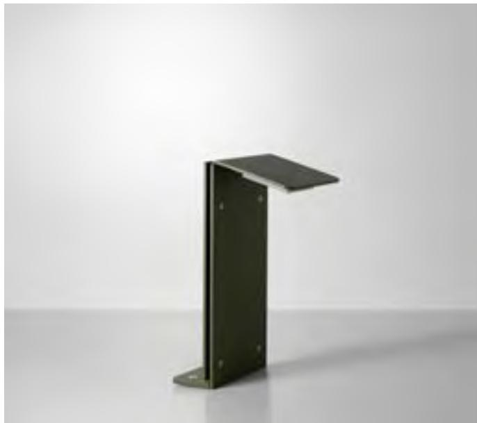
Paletto luminoso LED da esterno con ottica monodirezionale. Corpo lampada in alluminio verniciato ricavato da taglio laser e piegatura. Lente realizzata da monoblocco in PMMA trasparente e dissipatore interno in alluminio anodizzato nero. Circuito LED di potenza a tensione costante 24Vdc. Fissaggio mediante la predisposizione di un plinto in cemento con viti e tasselli di corredo.
