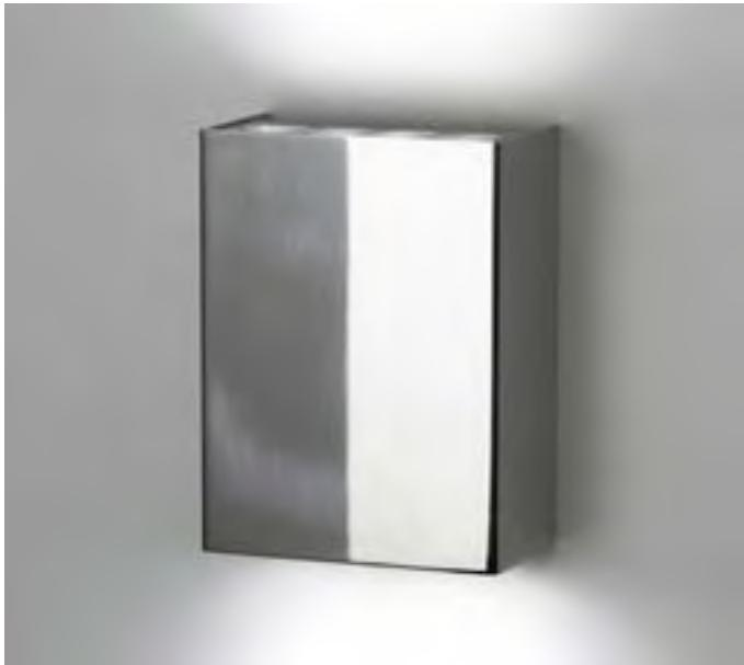
Applique LED biemissione per interni ed esterni . Ideale per l'illuminazione d'accento di facciate e architetture. Corpo realizzato in alluminio in pressofusione con trattamento superficiale di lucidatura ed anodizzazione nera. Corpo esterno in Acciaio Inox saldato. Quadrupla ottica in PMMA trasparente. Alimentazione on/off integrata.
