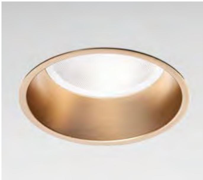
Incasso LED per interni. Corpo lampada in alluminio o rame tornito da lastra. Dissipatore posteriore in estruso di alluminio e molle in filo di acciaio armonico. Schermo frontale in PMMA microprismato per ottica diffusa 70°. Schermo frontale in PMMA trasparente per ottiche spot 22°, 36° o 55°.
