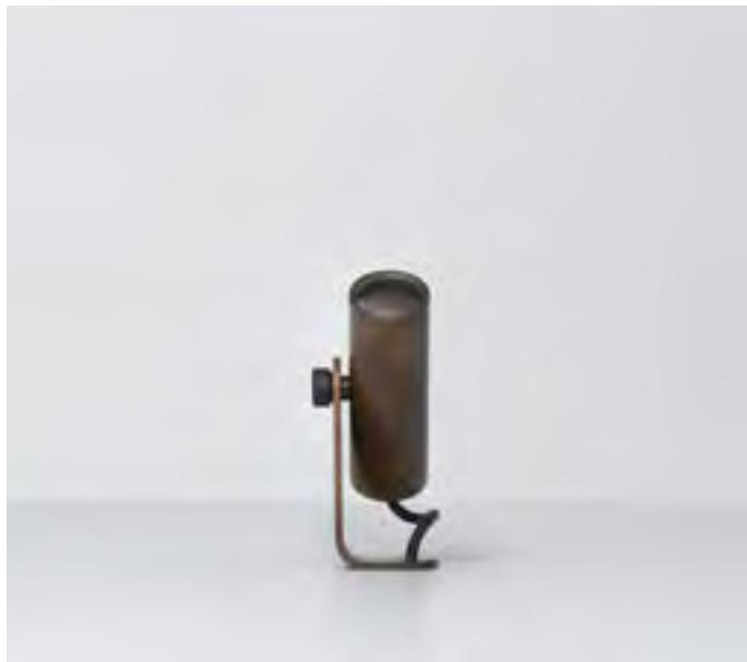
Proiettore LED per interni ed esterni . Ideale per l'illuminazione d'accento o di piccole alberature . Corpo realizzato da tornitura di alluminio con trattamento superficiale di anodizzazione, rame naturale o eventuale verniciatura. Ottica ad emissione spot 18°, 45° o diffusa 80° in PMMA trasparente.
