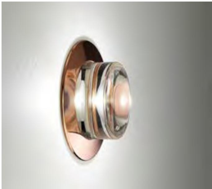
Segnapasso LED da incasso con ottica ad emissione radiale per interno ed esterno. Lente in PMMA trasparente vibrolucidato. Flangia in ottone con finitura galvanica, bronzo o verniciato. Guarnizioni OR in gomma siliconica (eccellente resistenza all'ozono, all'esposizione agli agenti atmosferici e all'invecchiamento).
