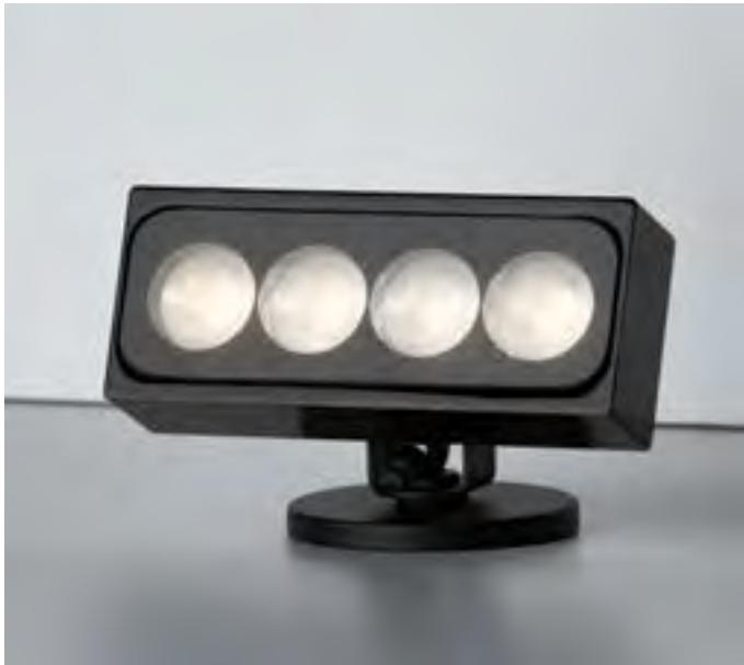
Proiettore LED direzionale per esterni con fissaggio a picchetto. Ideale per l'illuminazione d'accento. Corpo in alluminio Anodizzato nero pressofuso. Staffa di orientamento e fissaggio in Acciaio Inox Aisi 316. Quadrupla ottica in PMMA trasparente.
