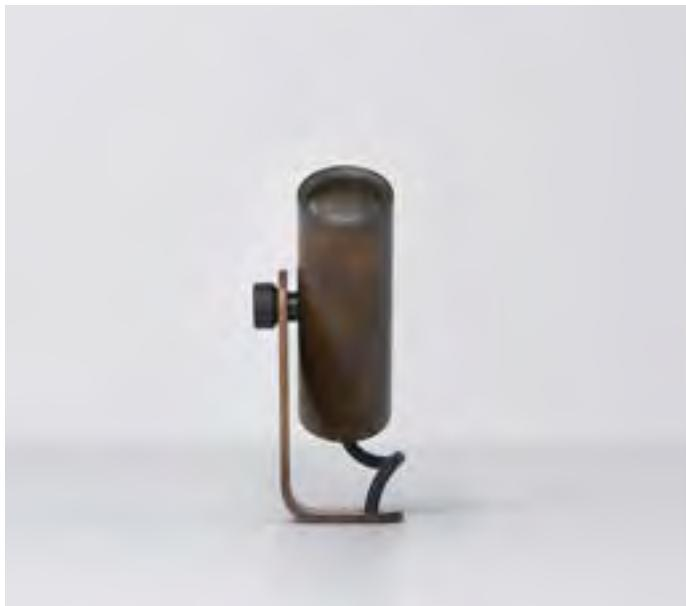
Proiettore LED per interni ed esterni . Ideale per l'illuminazione d'accento o di piccole alberature . Corpo realizzato da tornitura di alluminio con trattamento superficiale di anodizzazione, rame naturale o eventuale verniciatura. Ottica ad emissione spot 12° o 30° in PMMA trasparente.
