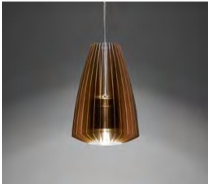
Sospensione LED con ottica ad emissione diffusa 90°. Ideale per l'illuminazione d'ambiente e centri tavolo. Corpo lampada in alluminio tornito ed alette dissipanti (x 30) in alluminio sp.0,8mm ricavate da taglio laser di precisione, microsatinitura superficiale ed anodizzazione. Ottica tornita da monoblocco di PMMA trasparente con superficie micropallinata per un miglior confort visivo ed una maggiore diffusione.
