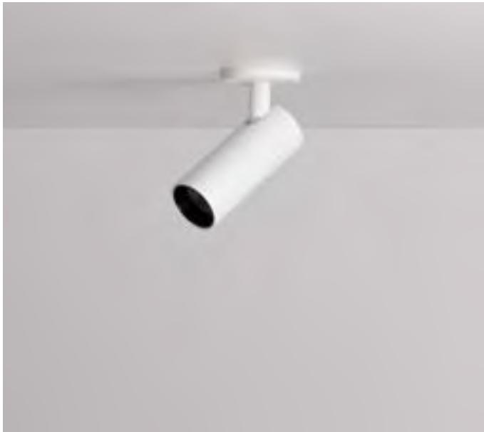
Proiettore LED orientabile da interno con base low-profile e molla per fissaggio su pannello o cartongesso. Ideale per l'illuminazione d'accento. Corpo lampada realizzati in alluminio tornito con verniciatura a polvere epossidica. Snodo in ottone tornito e base in ferro verniciato. Disponibili varie ottiche in PMMA trasparente. Anello frontale antiglare in alluminio anodizzato nero con finitura personalizzabile richiesta.
