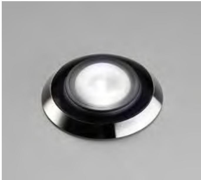
Incasso LED per interni ed esterni. Corpo realizzato in tornitura di alluminio con trattamento superficiale di anodizzazione nera. Flangia superiore in Acciaio Inox AISI316L o Bronzo Naturale. Ottica ad emissione spot in PMMA trasparente. Lente superiore tornito in PMMA trasparente.
