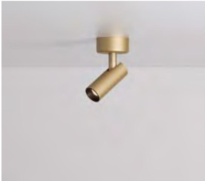
Proiettore LED orientabile da interno con rosone per fissaggio a soffitto. Ideale per l'illuminazione d'accento. Corpo lampada realizzati in alluminio tornito con verniciatura a polvere epossidica. Snodo in ottone tornito e base in ferro verniciato. Disponibili varie ottiche in PMMA trasparente. Anello frontale antiglare in alluminio anodizzato nero.
