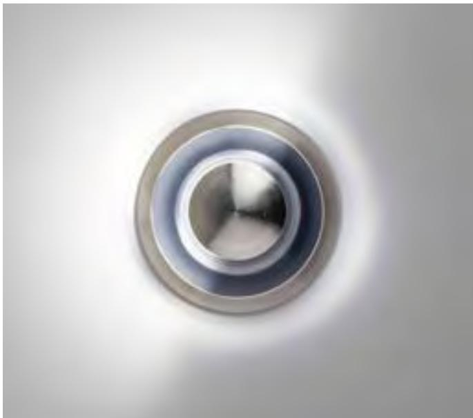
Segnapasso LED da incasso, ad emissione radiale per interni ed esterni. Corpo in alluminio anodizzato, lente in PMMA trasparente vibrolucidato, ghiera e schermo torniti in Acciaio Inox Aisi 316L o bronzo naturale. Ottica ad emissione radiale 360°, monodirezionale 180°, 90° o bidirezionale 90/90°.
