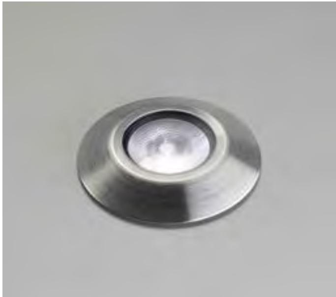
Incasso LED per interni ed esterni. Corpo realizzato in tornitura di alluminio con trattamento superficiale di anodizzazione nera. Flangia superiore in Acciaio Inox AISI316L o Bronzo Naturale. Ottica ad emissione spot in PMMA trasparente.
