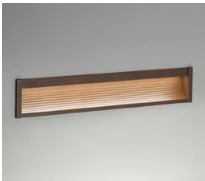
Segnapasso LED lineare da incasso per interni ed esterni con ottica diffusa arretrata. Corpo lampada in Alluminio trafiletato e vetrino in policarbonato opaco. Fornito con sistema di connessione rapida termoretraibile (vedi istruzioni di montaggio) o connettore rapido IP68. Alimentatore 24Vdc a bordo.
