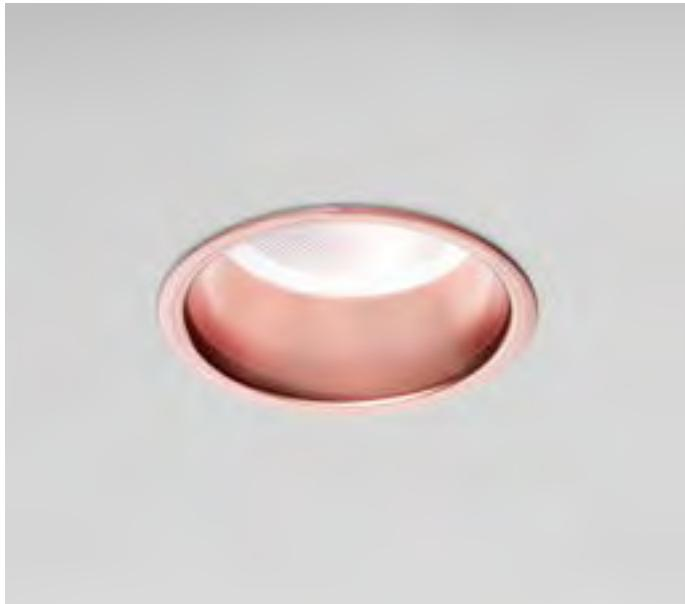
Incasso LED per interni. Corpo lampada in alluminio o rame tornito da lastra. Dissipatore posteriore in estruso di alluminio e molle in filo di acciaio armonico. Schermo frontale in PMMA microprismatico per ottica diffusa 70°. Schermo frontale in PMMA trasparente per ottiche spot 20°, 30° o 50°.
