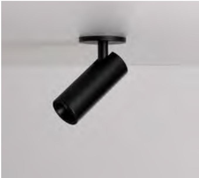
Proiettore LED direzionale da interno con base low-profile e molla per fissaggio su pannello o cartongesso. Ideale per l'illuminazione d'accento. Corpo lampada realizzati in alluminio tornito con verniciatura a polvere epossidica. Snodo in ottone tornito e base in ferro verniciato. Disponibili varie ottiche in PMMA trasparente. Anello frontale antiglare in alluminio anodizzato nero con finitura personalizzabile a richiesta.
