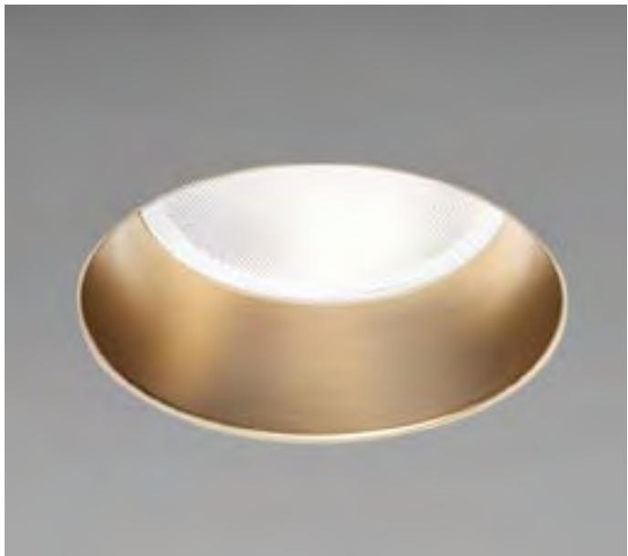
Incasso LED a rasare per interni. Corpo lampada in alluminio o rame tornito da lastra. Dissipatore posteriore in estruso di alluminio e molle in filo di acciaio armonico. Schermo frontale in PMMA microprismatico per ottica diffusa 70°. Schermo frontale in PMMA trasparente per ottiche spot 22°, 36° o 55°.
