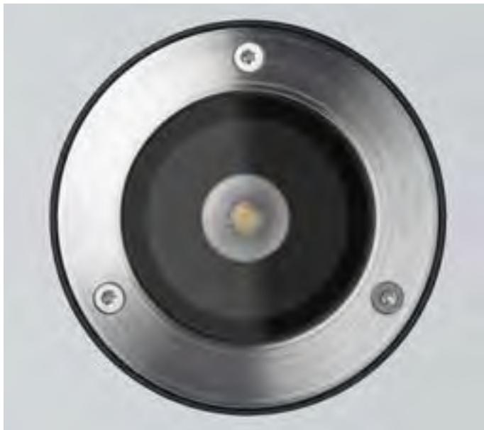
Incasso LED per esterni. Ideato per l'illuminazione uplight di facciate e architetture. Corpo dissipante in alluminio tornito da pieno con trattamento superficiale di anodizzazione dura colore nero. Ghiera esterna in Acciaio Inox AISI 316 L o Bronzo naturale. Schermo superiore in vetro temperato extra-chiaro serigrafato (sp.4mm). Lente interna in PMMA trasparente.
