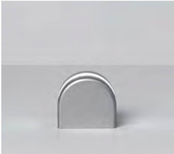
Plafone LED da esterno ed interno per l'illuminazione architettonica di edifici e strutture con ottica asimmetrica. Corpo lampada in alluminio ricavato da macchina CNC e lente tornita da monoblocco di PMMA trasparente 8°x180°. Finitura superficiale di micro pallinatura e anodizzazione o verniciatura RAL. Sorgente LED multi-chip con resinatura incapsulante trasparente.
