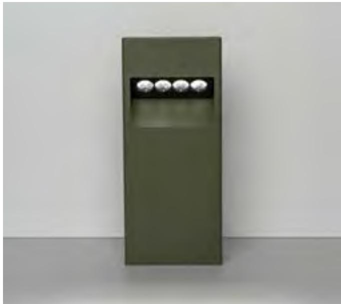
Paletto LED da giardino . Corpo lampada esterno in acciaio inox verniciato. Quadrupla ottica in PMMA trasparente. Alimentazione on/off integrata. Fissaggio mediante la predisposizione di un plinto in cemento con viti e tasselli di corredo.
