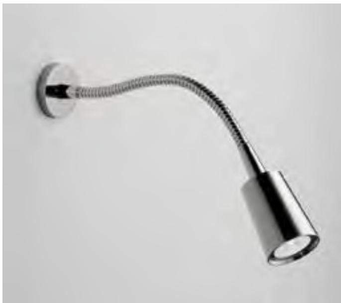
Applique LED per interni con braccio flessibile. Ideale per testa letto e luce da lettura. Testa lampada in alluminio tornito, braccio flessibile in ottone e placca di fissaggio in ottone tornito. Trattamento superficiale di galvanica Cromo Lucido o Opaco. Ottica spot 30° in PMMA trasparente.
