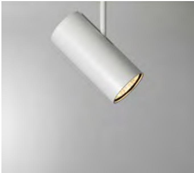
Proiettore LED da interno con fissaggio a soffitto oppure a sistema binario Ideale per l'illuminazione d'accento. Corpo realizzato da tornitura di alluminio con trattamento superficiale di verniciatura. Ottica ad emissione spot e schermo in PMMA trasparente serigrafato. Alimentatore ON/OFF a bordo.
