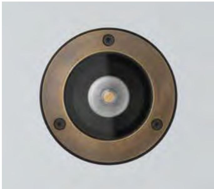
Incasso LED per esterni. Ideato per l'illuminazione segnaletica diffusa. Corpo dissipante in alluminio tornito da pieno con trattamento superficiale di anodizzazione dura colore nero. Ghiera esterna in Acciaio Inox AISI 316 L o Bronzo naturale. Schermo superiore in vetro temperato extra-chiaro serigrafato (sp.4mm). Schermo diffusore interno in PMMA opale micro-prismato.
