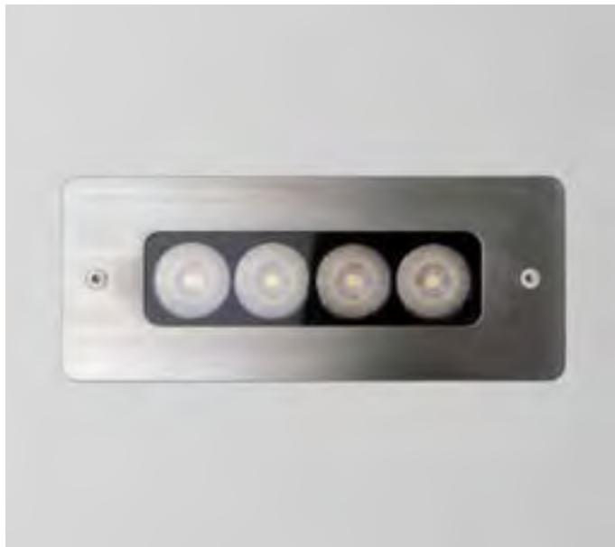
Incasso LED per interni ed esterni . Ideale per l'illuminazione d'accento di facciate e architetture. Corpo realizzato in alluminio in presofusione con trattamento superficiale di lucidatura ed anodizzazione nera. Flangia superiore e cassaforma in Acciaio Inox AISI316L. Quadrupla ottica in PMMA trasparente. Schermo superiore in vetro extra chiaro serigrafato.
