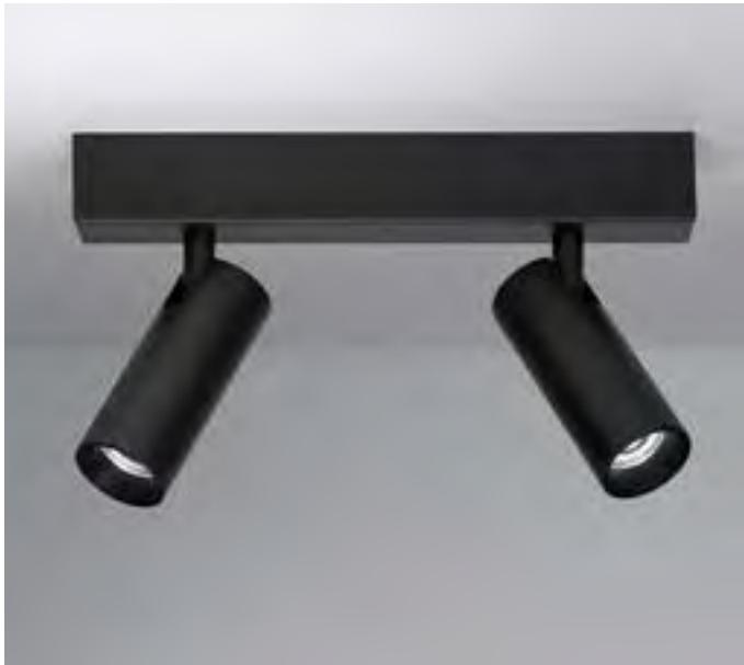
Apparecchio LED orientabile con 2 proiettori per parete o soffitto da interno. Ideale per l'illuminazione d'accento. Corpo lampada realizzato in alluminio tornito con verniciatura a polvere epossidica. Snodo in ottone tornito e base in ferro verniciato. Disponibili varie ottiche in PMMA trasparente. Anello frontale antiglare in alluminio anodizzato nero con finitura personalizzabile richiesta. Alimentazione ON/OFF integrata.
