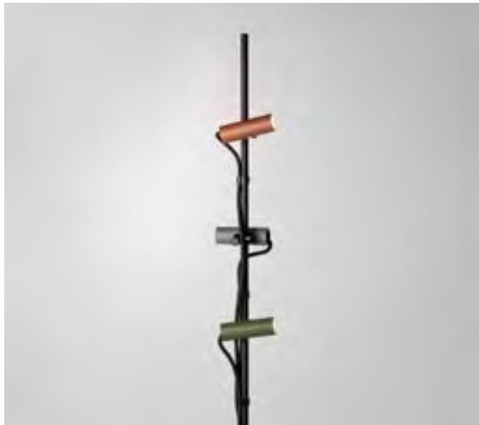
Proiettore LED per interni ed esterni . Ideale per l'illuminazione d'accento o di piccole alberature . Corpo realizzato da tornitura di alluminio con trattamento superficiale di anodizzazione, rame naturale o eventuale verniciatura. Ottica ad emissione spot 18°, 45° o diffusa 80° in PMMA trasparente. Prodotto ideale per l'installazione multipla direzionale su asta.
