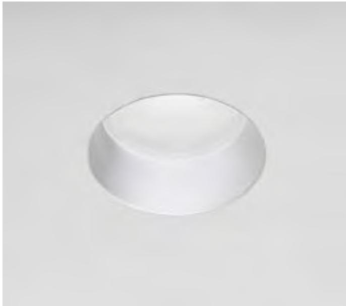
Incasso LED a rasare per interni. Corpo lampada in alluminio o rame tornito da lastra. Dissipatore posteriore in estruso di alluminio e molle in filo di acciaio armonico. Schermo frontale in PMMA microprismatico per ottica diffusa 70° o spot 20°, 30° o 50°. Schermo frontale in PMMA trasparente per ottiche spot.
