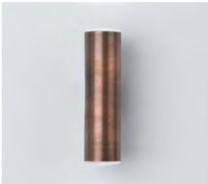
Applique LED a doppia emissione per interni ed esterni. Corpo dissipante interno in alluminio anodizzato nero e corpo esterno in ottone naturale tornito. Ottica ad emissione spot 12° o 30° in PMMA trasparente. Schermo superiore tornito in PMMA trasparente.
