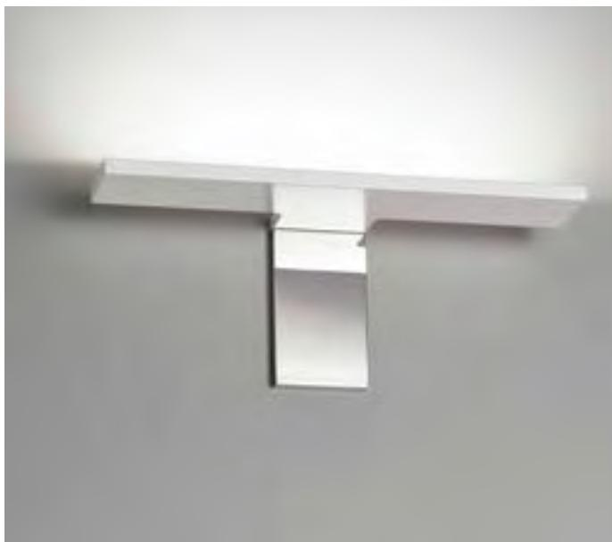
Applique LED mono-emissione da interno. Ideale per l'illuminazione d'ambiente. Corpo lampada e base realizzati in alluminio lavorato CNC con trattamento superficiale di anodizzazione o verniciatura. Possibilità di comporre la propria lampada con differenti finiture per base e corpo. Disponibile nelle versioni Sinistra, Destra e Centrale. Ottica ad emissione diffusa 120°. Alimentatore ON/OFF remoto.
