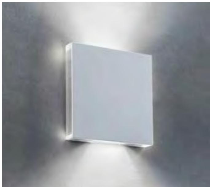
Applique biemissione per interni. Corpo lampada in alluminio ricavato da taglio laser. Lente esterna in PMMA trasparente ricavata da lavorazione CNC. Schermo frontale in alluminio, rame o vetro specchiato.
