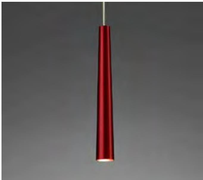
Sospensione LED con ottica spot 30° o diffusa 80°. Ideale per l'illuminazione d'ambiente e centri tavolo. Corpo lampada esterno in alluminio conificato e dissipatore interno in alluminio Anodizzato nero tornito. Ottiche in PMMA trasparente tornita.
