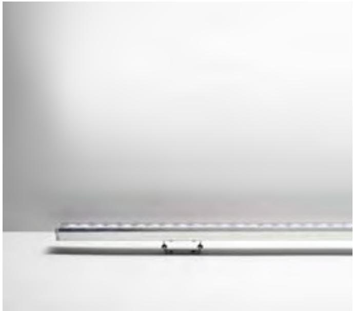
Profilo LED lineare per esterni. Ideale per l'illuminazione architettonica di edifici e facciate. Profilo dissipante trafilato in alluminio, con lavorazione CNC, schermo in vetro extrachiaro serigrafato e staffe in Acciaio Inox AISI316L. Ottica ad emissione spot o ellittica in PMMA trasparente.
