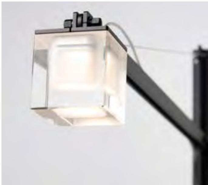
Applique LED con braccio estensibile per interni. Ideale per testa letto e luce ambiente. Corpo lampada in alluminio ricavato da taglio laser, Lente in PMMA trasparente con satinatura interna. Ottica interna diffusa in PMMA trasparente.
