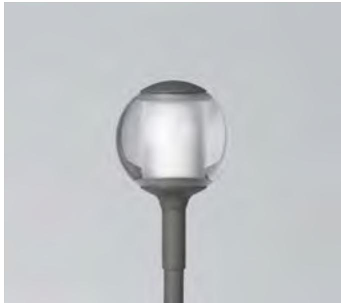
Bollard LED per esterni. Ideale per l'illuminazione di giardini. Corpo dissipante realizzato in alluminio tornito con ossidazione anodica nera. Ottica ad emissione radiale 360° realizzata da monoblocco di PMMA trasparente tornito. Asta in ottone tornito verniciato.
