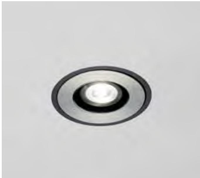
Incasso LED per interni ed esterni. Corpo interno dissipante realizzato in tornitura di alluminio con trattamento superficiale di anodizzazione nera. Flangia superiore tonda in Acciaio Inox AISI316L, bronzo naturale, ottone naturale o verniciata. Ottica ad emissione spot 16° o diffusa 90° in PMMA trasparente.
