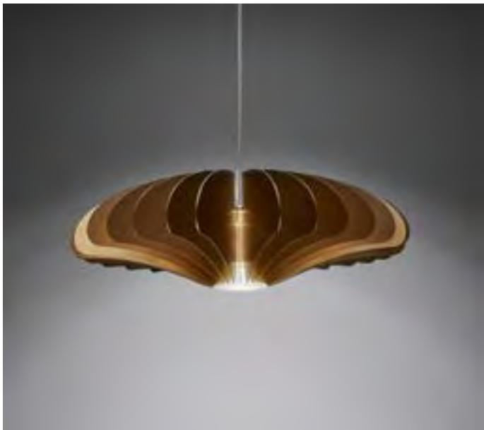
Sospensione LED con ottica ad emissione diffusa 90°. Ideale per l'illuminazione d'ambiente e centri tavolo. Corpo lampada in alluminio tornito ed alette dissipanti (x 30) in alluminio sp.0,8mm ricavate da taglio laser di precisione, microsatina superficiale ed anodizzazione. Ottica tornita da monoblocco di PMMA trasparente con superficie micropallinata per un miglior confort visivo ed una maggiore diffusione.
