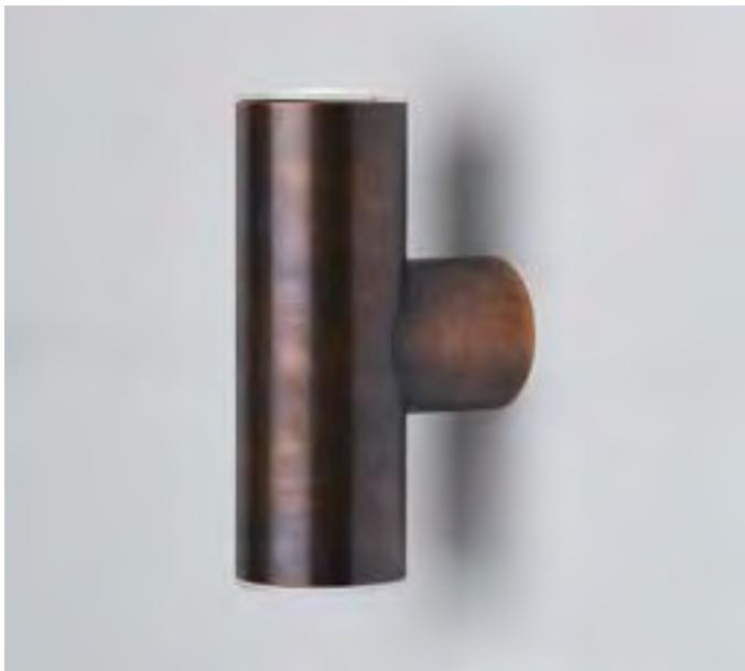
Applique LED a doppia emissione per interni ed esterni. Corpo dissipante interno in alluminio anodizzato nero e corpo esterno in ottone naturale tornito. Ottica ad emissione spot 20°, 30° o 50° in policarbonato. Schermo superiore tornito in PMMA trasparente. Alimentazione on/off integrata
