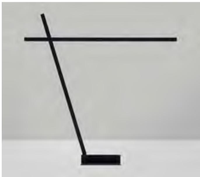
Lampada LED da tavolo per interni. Corpo lampada in Alluminio Anodizzato e base in Ferro lavorato a CNC e verniciato. Interruttore ON/OFF sulla base della lampada. Ottica diffusa 120° in PMMA opaco. Circuito LED SMD lineare CRI ≥90. Fornita con alimentatore a spina 120/240Vac.
